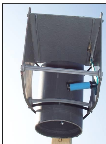
Figure 5. - Exemple d'implantation d'un tube passif dans son abri de protection
