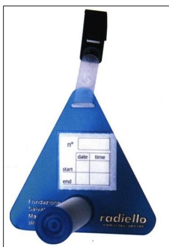
Figure 4. - Tube à diffusion passive - Ensemble support - corps diffusif - cartouche
