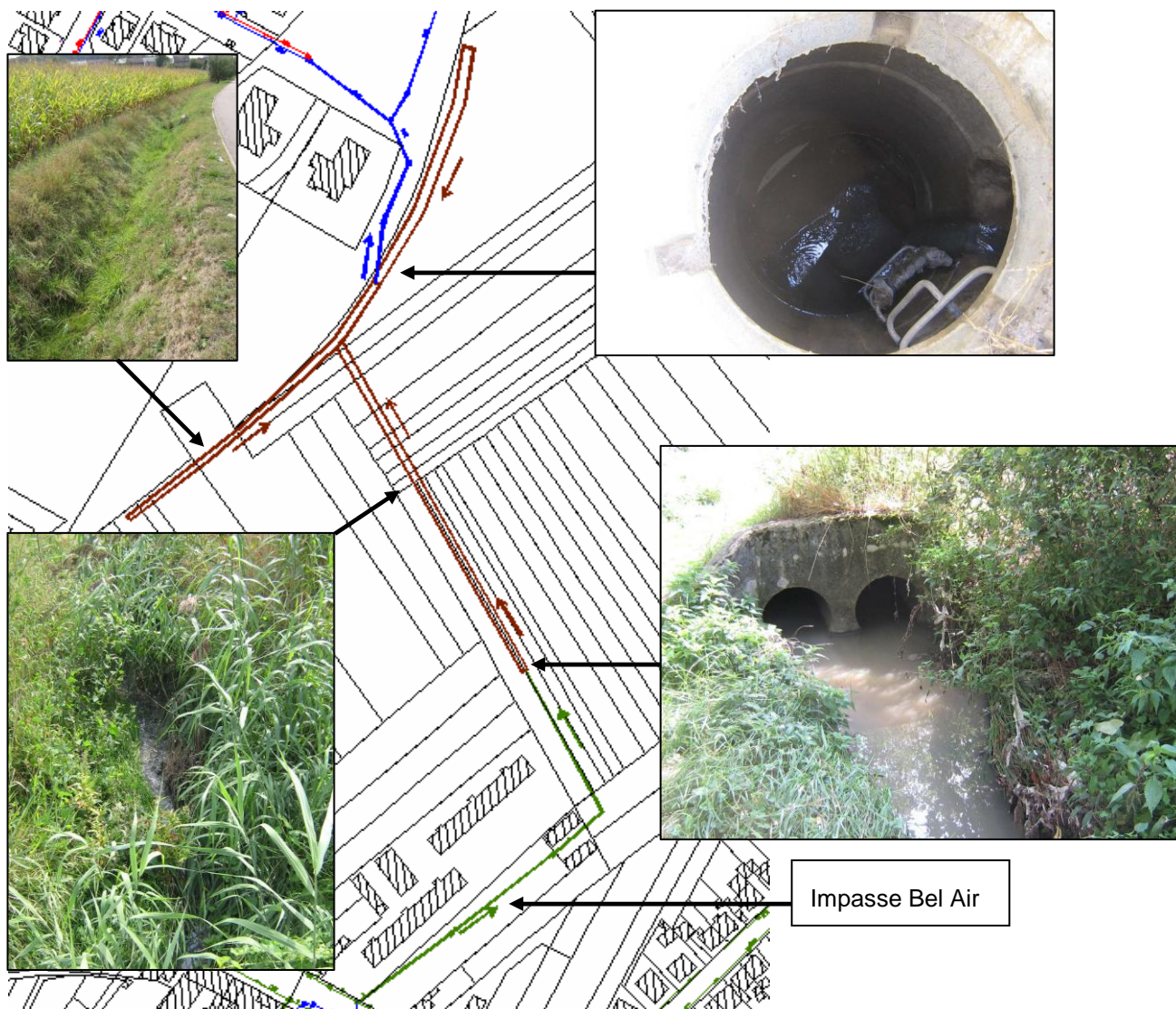
Figure 3 : Problème observé sur le réseau d'assainissement
